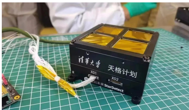
天格计划 GRID-10B 卫星载荷实物图
