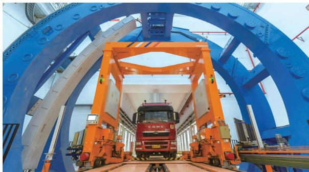
全球首套基于高能电子直线加速器的大型货物车辆 CT 检查系统
