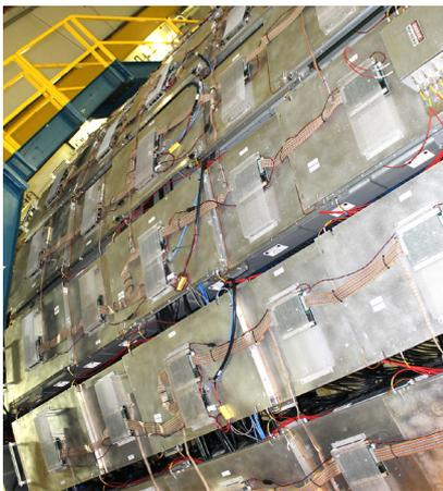
由 MRPC 探测器模块组成的 RHIC-STAR 新型缪子探测器
