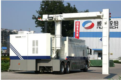
加速器辐射源移动式集装箱检查系统
