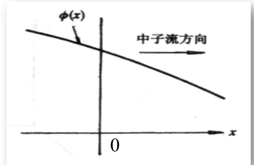
单位时间单位体积，中子散射到右边的比散射到左边的多
